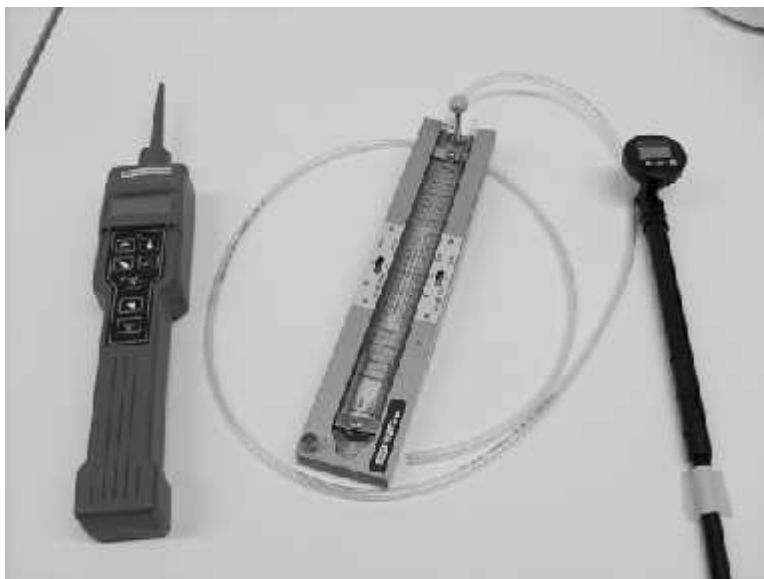
Figur 7: Till vänster visas läcktestaren som används för att detektera eventuella heliumläckor. I mitten visas ett U-rör för mätning av tryckskillnader mellan de olika sektionerna i modellen. Till höger visas luftflödesmätaren vilken används för att bestämma luftflödes hastigheten i utsugsröret och därmed luftomsättningen i de olika sektionerna av modellen.
