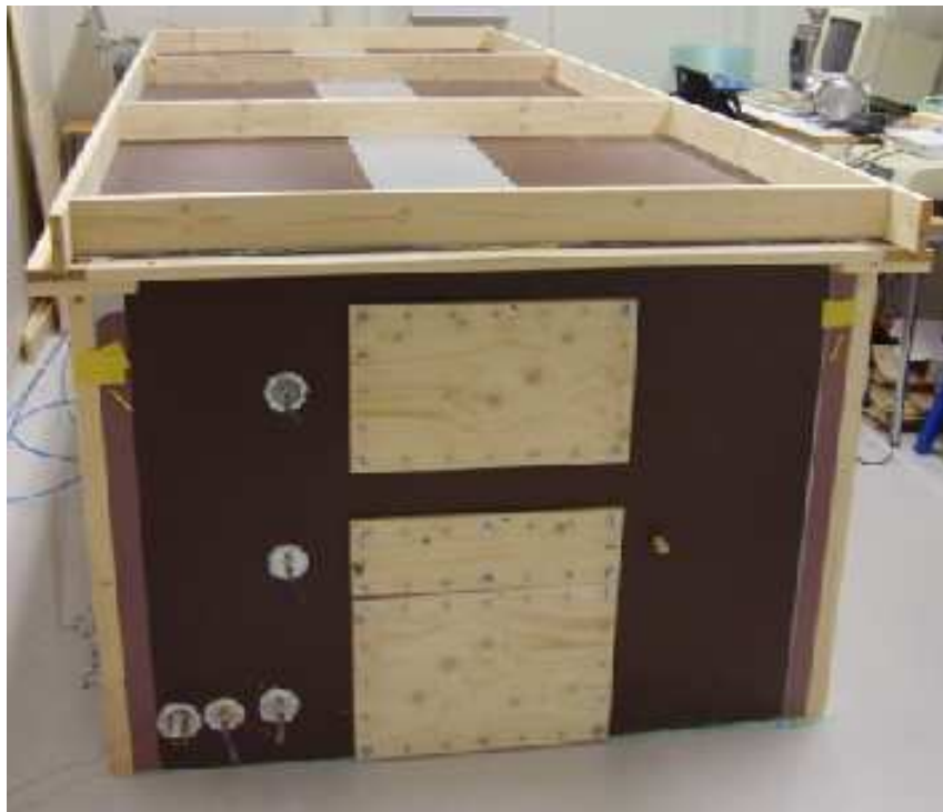
Figur 6: Figuren visar den färdiga modellen. På kortsidan ser man ventilerna som används för tryckmätning och de inspektionluckor genom vilka koldosorna ställs in och tas ut.
