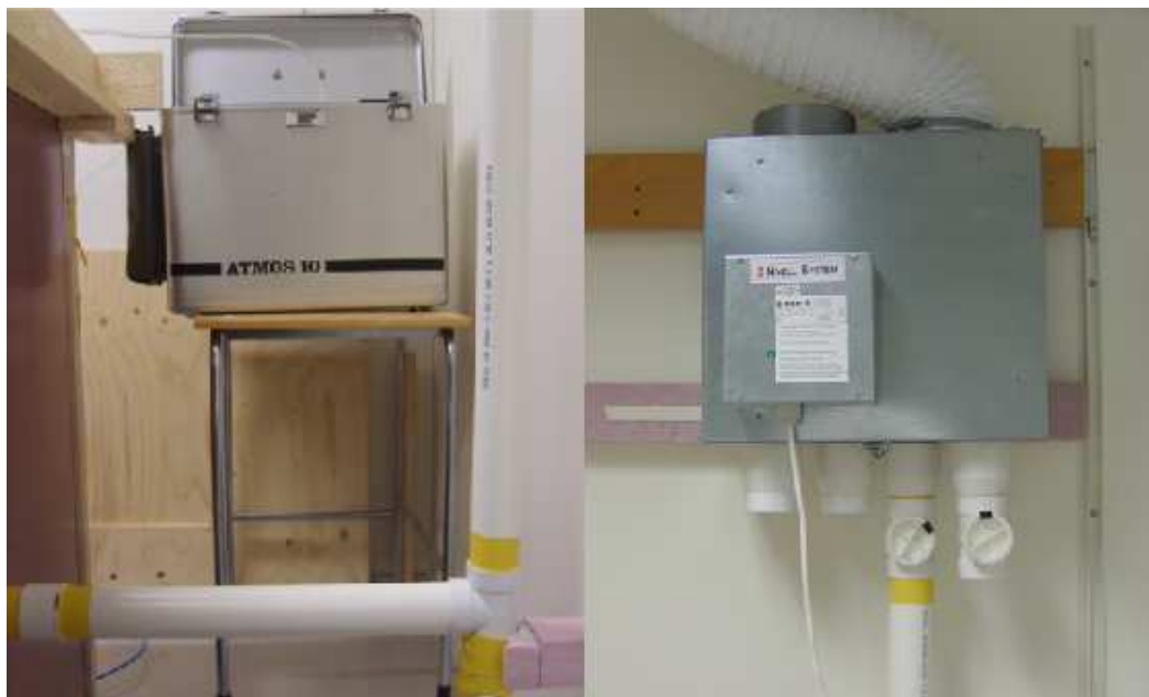
Figur 5: Till vänster visas utsugsröret genom modellens kortsida och ATMOS som är ett instrument för kontinuerlig mätning av radongashalten. En närmre beskrivning av ATMOS följer i sektionen Mätutrustning . Till höger visas den fläkt som användes.
