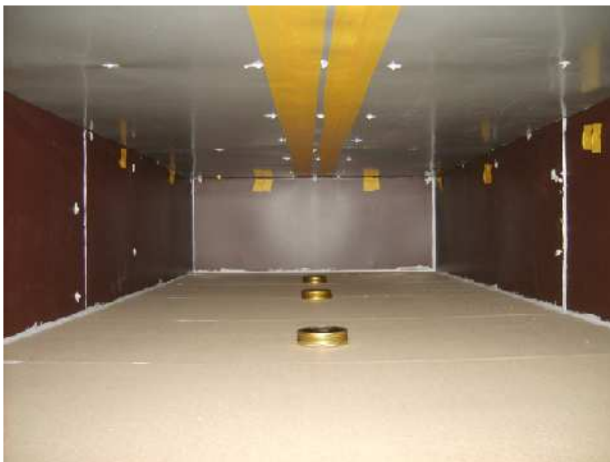
Figur 10: Figuren visar hur koldosorna placerades i modellens övre sektion.
